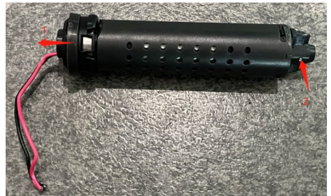
09. Commencez par retirer le support de roulement dans le sens de la flèche au point 1, puis poussez la tige dans le sens de la flèche au point 2 pour retirer le support d'entraînement du rouleau-brosse.
