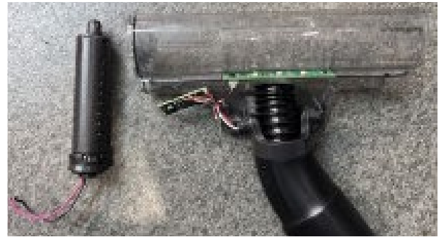
09. Commencez par retirer le support de roulement dans le sens de la flèche au point 1, puis poussez la tige dans le sens de la flèche au point 2 pour retirer le support d'entraînement du rouleau-brosse.
