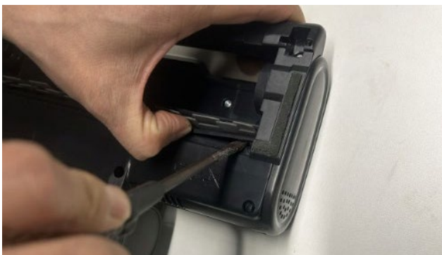
05. Fixer le clapet à l'aide d'un tournevis droit.
