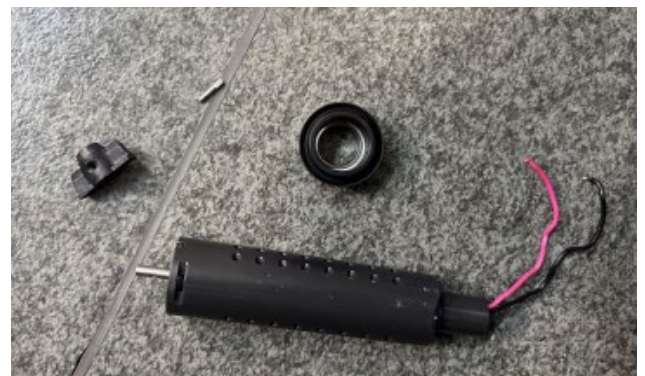
10. Retirez les vis et retirez la couverture avant du moteur.
