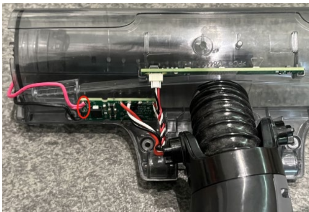
08. Coupez les fils du moteur connectés à la carte circuit imprimé.
